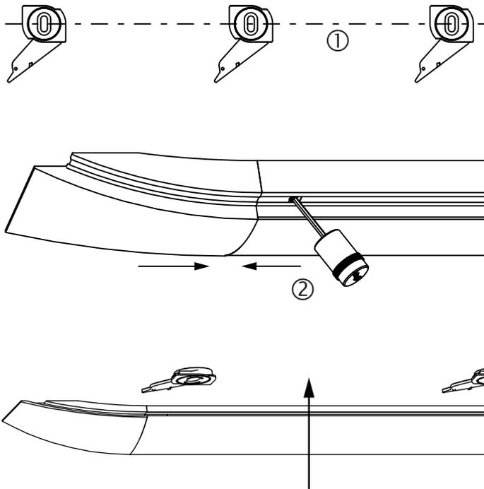
1. Spannriegel an die Decke montieren. Dabei auf genaue Flucht achten. (Langlöcher) ①
